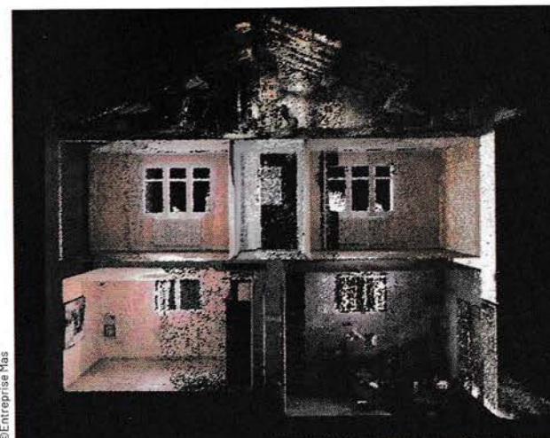
Voici le nuage de points issu du relevé sur site à l'aide d'un scanner 3D (360 000 balayages laser par seconde).
